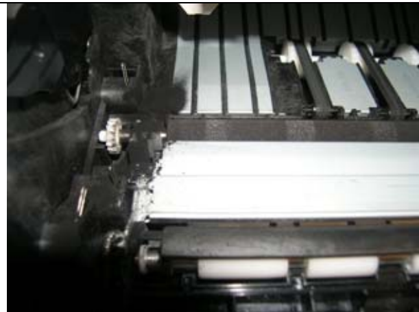
Marchio D – Cartuccia guasta prematuramente (PF) che perde toner all'interno della stampante.
